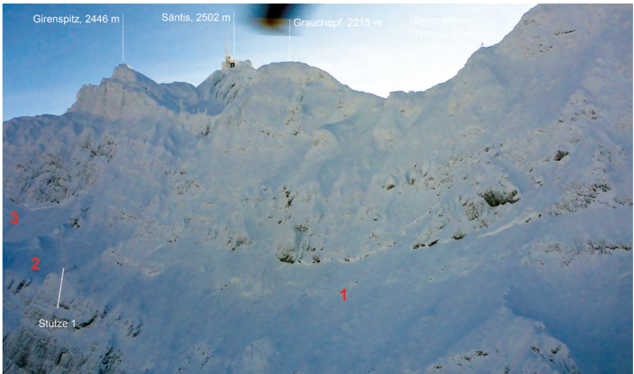
Abbildung 104: Anrissbereich der Hauptlawine Nr. 1 mit dem Band «in den Schnüeren» an deren oberen Grenze auf rund 1900 m die Lawine anbrach. Die Anrisshöhen betragen durchschnittlich rund 1,5 m, maximal bis etwa 2,5 m wobei dies nur aus der Luft abgeschätzt wurde (Foto: P. Diener, 11.01.2019).
